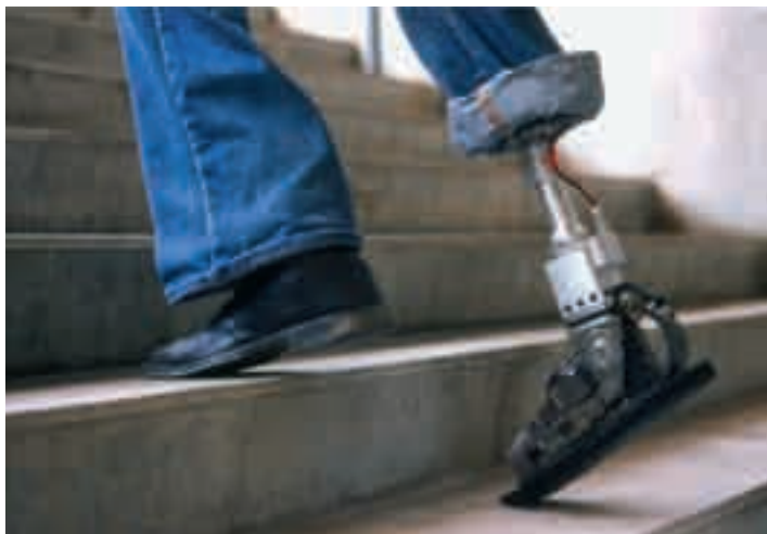
Figura 1. Prótesis robótica de tobillo-pie de Biomechatronics (fotografía de Webb Chappell •MIT Media Lab) y prototipo más reciente de iWalk LLC
