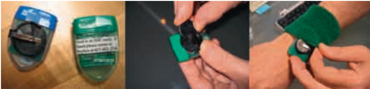
Figura 4. Sensores con acelerómetro inalámbrico de tres ejes MITes alojados en carcasas de plástico con soporte de batería externo. Las carcasas se pueden llevar en las muñecas con un brazalete elástico
